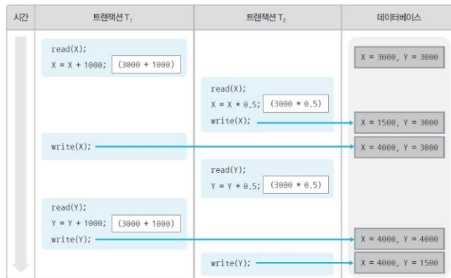
그림 10-39 트랜잭션 T_1 과 T_2 에 대한 비직렬 스케줄의 예 2 : 잘못된 결과 생성
